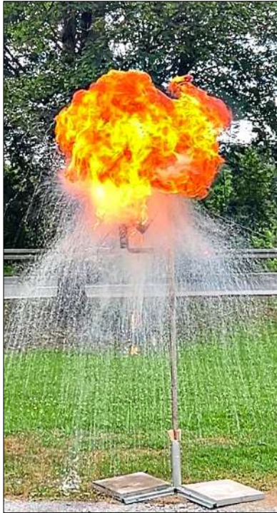
Achtung: Das Löschen eines Fettbrandes mit Wasser kann gefährliche Folgen haben.
